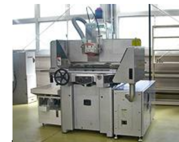
製造メーカー：黒田精工 株式会社 機種：成形平面研削盤 型番：GS-45 寄贈者：黒田精工 株式会社
