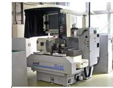
製造メーカー：株式会社 テクノワシノ 機種：光学式精密ならい研削盤 型番：GLS-5T 寄贈者：株式会社テクノワシノ
