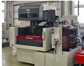
製造メーカー：三菱電機 株式会社 機種：ワイヤカット放電加工機 型番：FA10SM 寄贈者：三菱電機 株式会社
