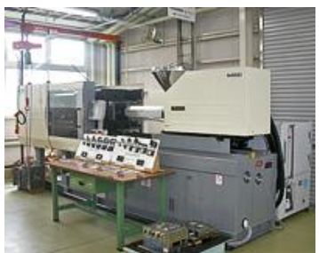
製造メーカー：日精樹脂工業 株式会社 機種：電気式高性能射出成形機 型番：NEX110-12E 寄贈者：日精樹脂工業 株式会社
