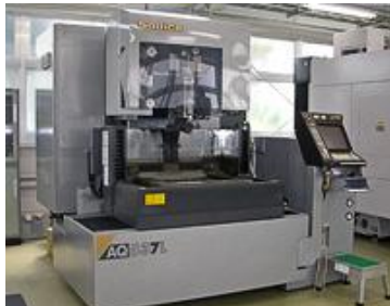
製造メーカー：株式会社 ソディック 機種：リニアモータ駆動ワイヤ放電加工機 型番：AQ537L 寄贈者：株式会社 ソディック
